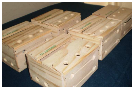
Figura 5. Caixa de madeira para colocação dos sensores Fonte: Arquivo da Autora.
