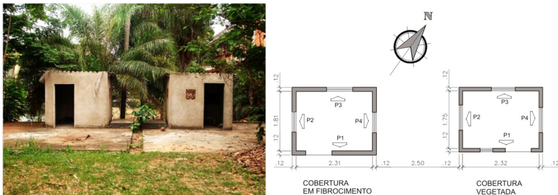
Figura 01 –Protótipos selecionados no campus da UFMT (painel esquerdo) e a planta baixa (unidades em metros) dos protótipos (painel da direita).
