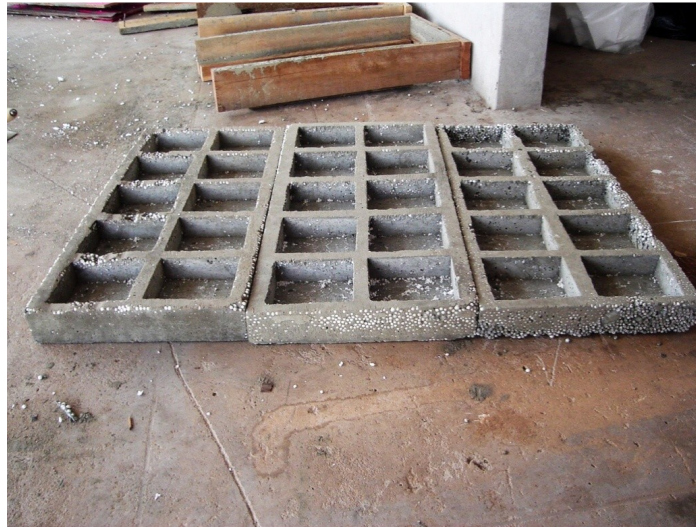
Figura 02 – Placas de concreto para suportar a vegetação.
