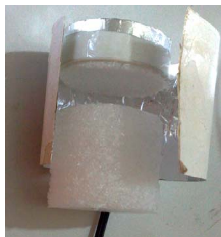
Figura 8 – Preenchimento com isolante.
