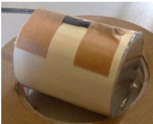
Figura 7 – Fixação dos sensores.
