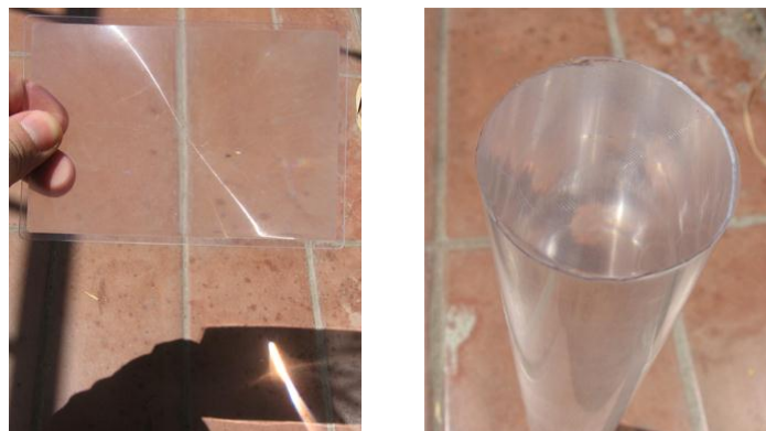
Figura 7 - Lente de Fresnel flexible. Izquierda, visualización del foco; derecha, aplicación sobre la zona de colección
