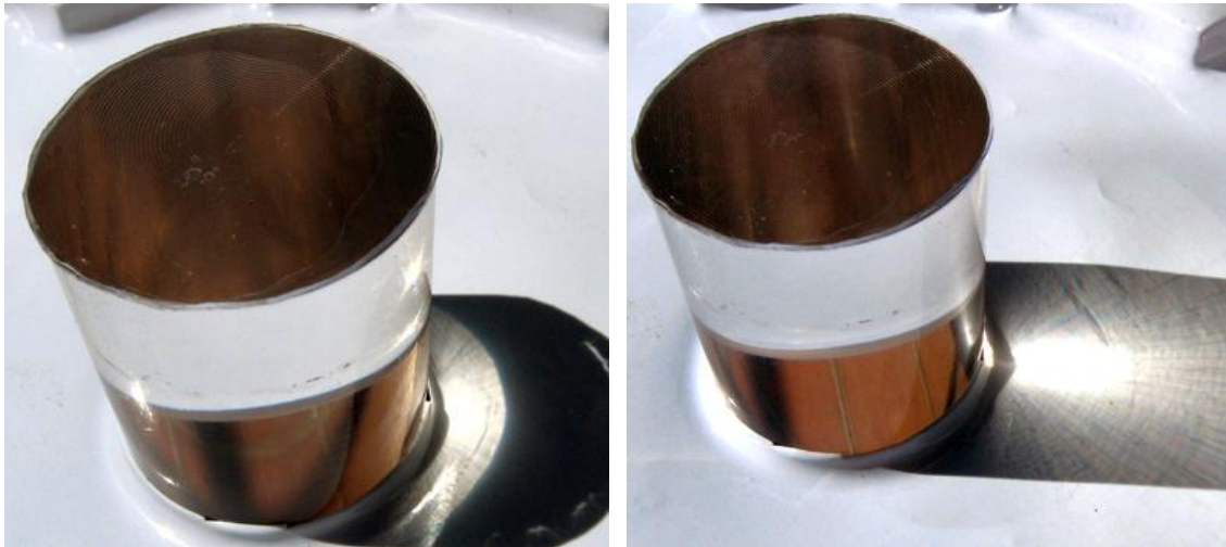
Figura 8 - Foco de la lente de Fresnel. Izquierda, foco contenido en la barra; derecha foco fuera del diámetro de la barra
