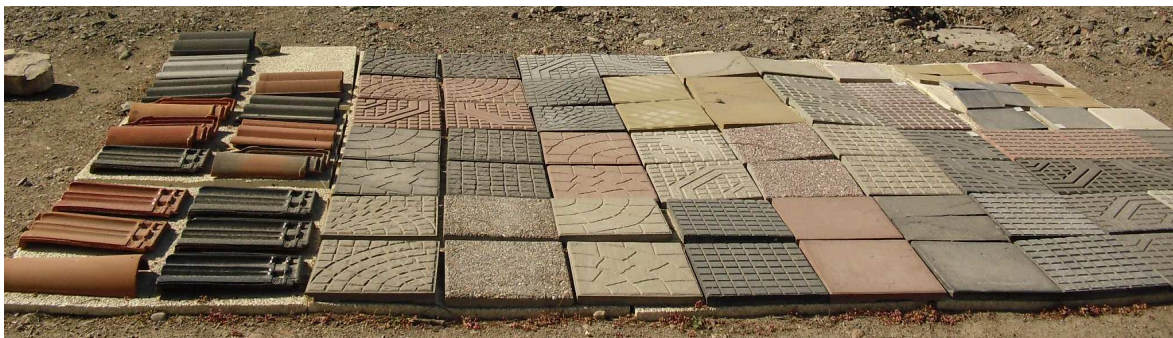
Figura 2. Evaluación térmica y óptica de los materiales en el predio.
