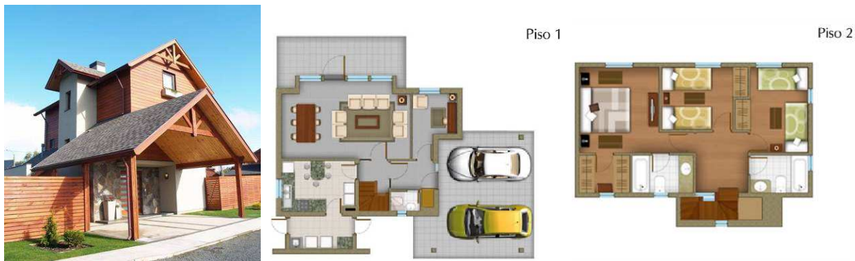
Figura 19, 20 y 21. - Condominio Frankfurt, Temuco. La casa piloto recibió un certificado que muestra un consumo energético de 27kWh/m 2 /año. ( www.worner.cl y www.condominiofrankfurt.cl )
