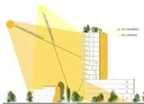
Figura 2. Estudios técnicos de funcionamiento bioambiental: incidencia y protección solar, estrategias de ventilación natural, protección de viento y optimización del comportamiento térmico.
