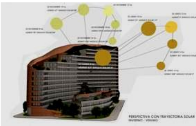
Figura 2. Estudios técnicos de funcionamiento bioambiental: incidencia y protección solar, estrategias de ventilación natural, protección de viento y optimización del comportamiento térmico.
