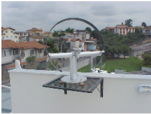
Figura 3 – Anel de sombreamento e sensor instalados na estação (SANTOS, 2003).
