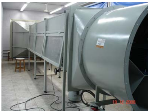
Figura 1 – Foto tirada durante a montagem do túnel de vento de camada limite atmosférica, no Laboratório de Conforto Ambiental, da Faculdade de Engenharia Civil, Arquitetura e Urbanismo da Unicamp.
