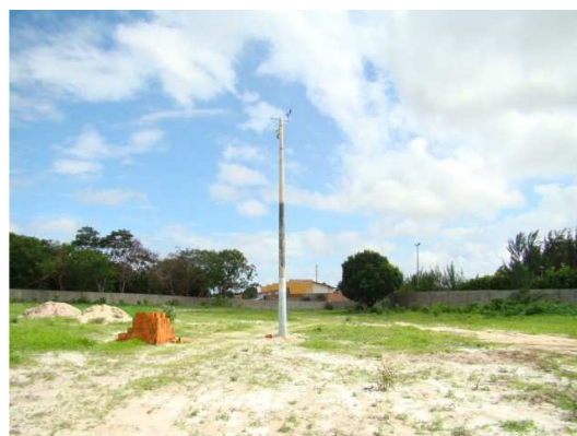
Figura 2 – Estação meteorológica HOBO Weather Station H21-001 acoplada a poste de 10 metros de altura área de estudo. Fonte: Arquivo de dados da pesquisa.
