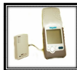
Figura 4– Sensor automático de CO 2 , temperatura e umidade relativa.
