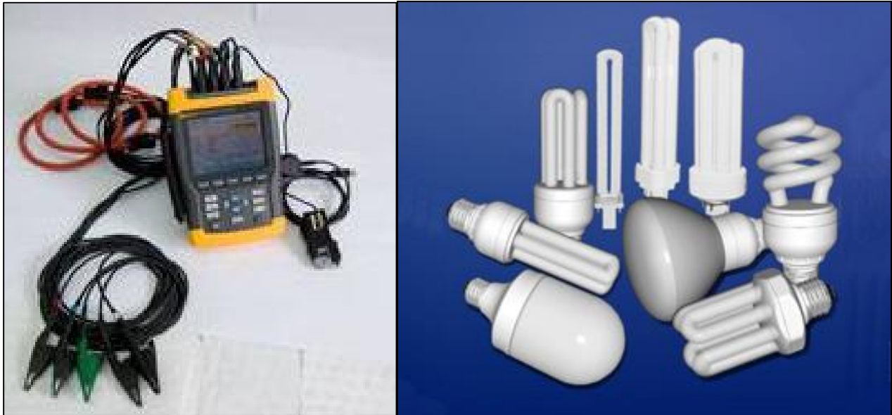
Figura 1 - Equipo analizador de parámetros eléctricos utilizado (FLUKE modelo 435) y ejemplos de las diferentes lámparas fluorescentes compactas estudiadas
