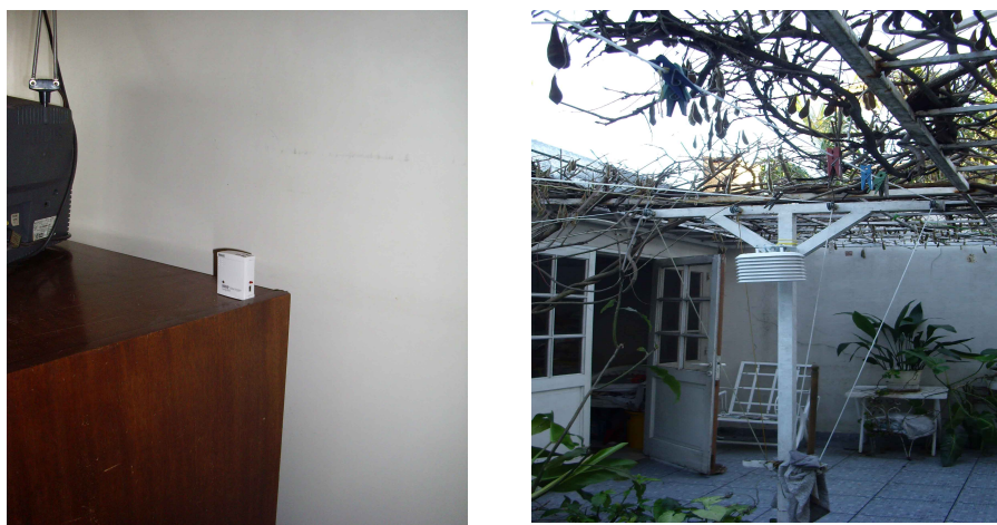
Figura 4 ejemplo de ubicación de microadquisidor de datos HOBOWarePro en uno de los dormitorios. A la derecha ubicación de la estación meteorológica en el patio de la vivienda.
