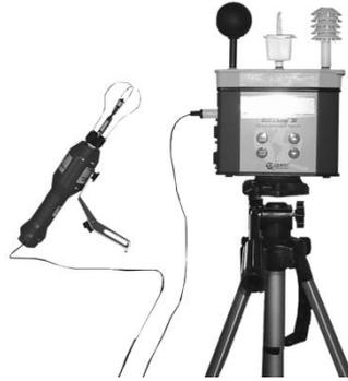
Figura 3 – Monitor de estrés térmico y anemómetro omnidireccional
