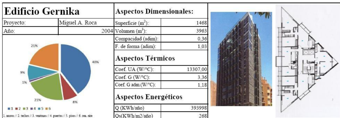
Figura 5: Descripción básica del edificio.
