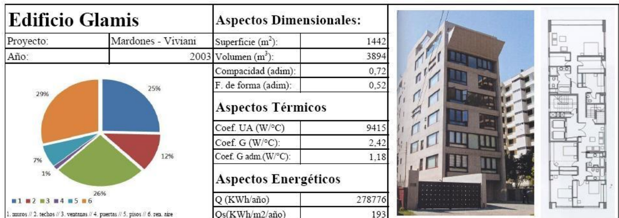
Figura 4: Descripción básica del edificio.
