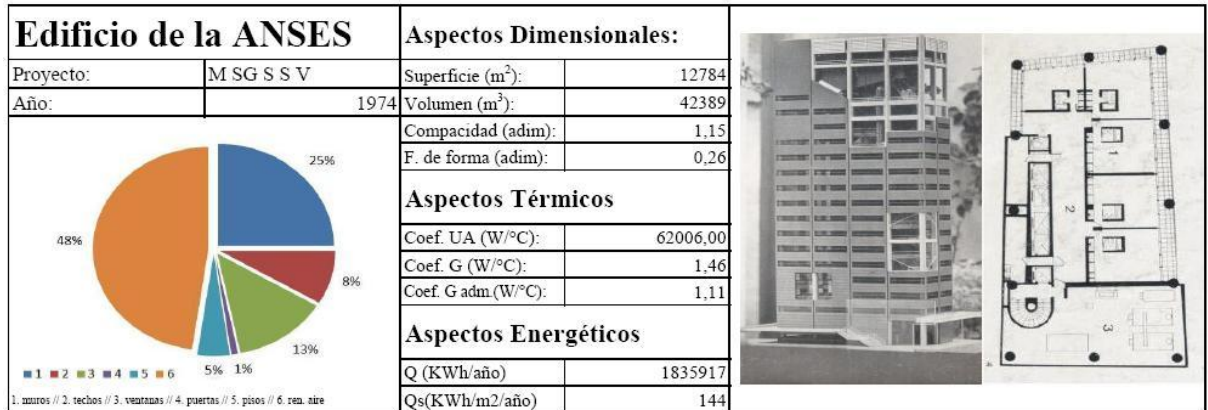
Figura 3: Descripción básica del edificio.
