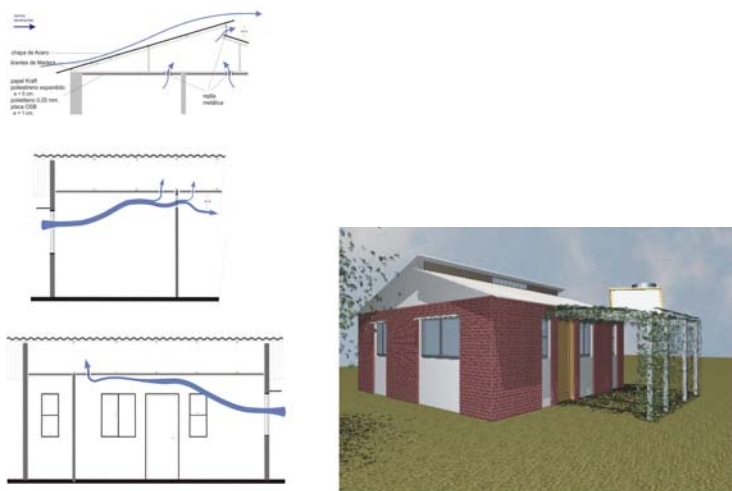
Fig. 12 Propuesta de ventilación natural por termosifón. Genes, Hernández y Remigio, 2008
