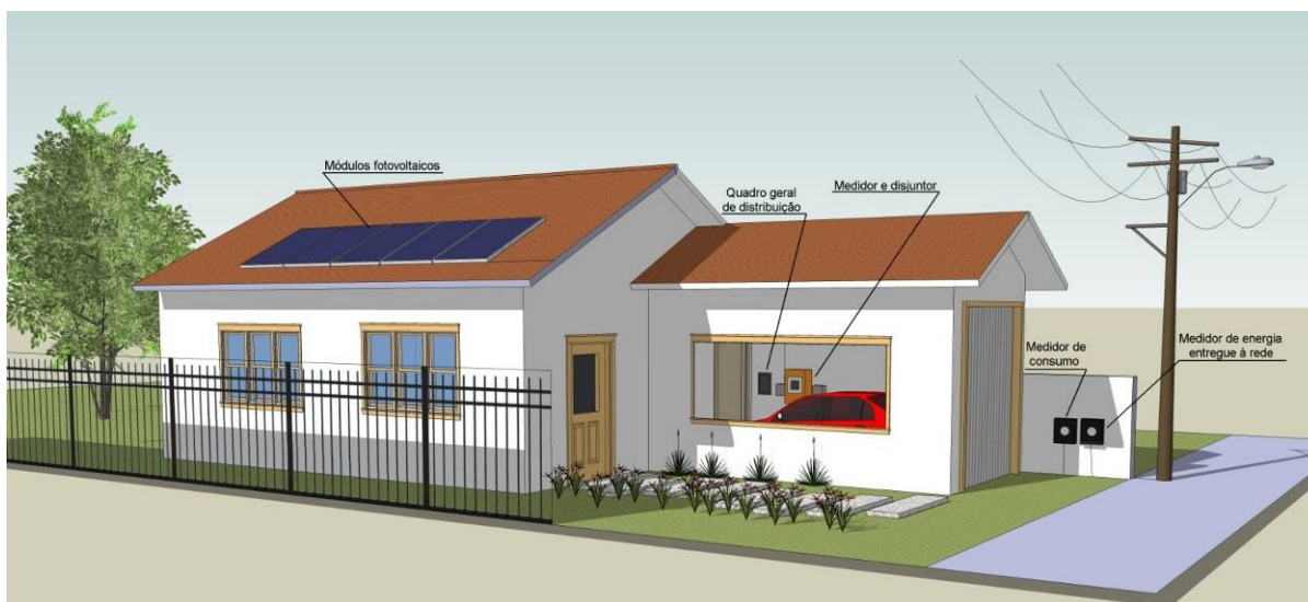
Figura 6 – Modelo de integração do kit fotovoltaico em uma habitação
