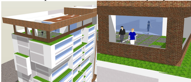
Figura 16: Tetos-jardim para redução da carga térmica Fonte: Acervo do autor
