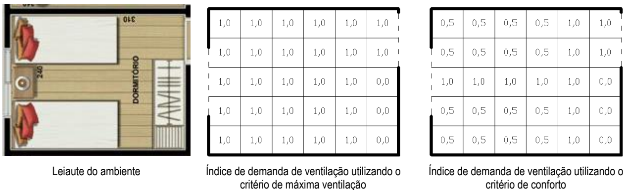
Figura 3 – Comparação entre os resultados obtidos utilizando dois critérios diferentes para o índice de demanda de ventilação
