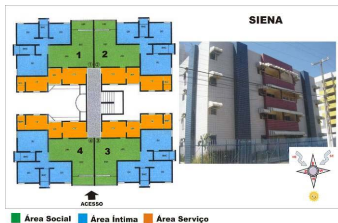
Figura 3. Planta do pavimento tipo do Edifício Siena, foto da fachada Oeste, e esquema da direção dos ventos
