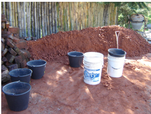
Figura 3 – Substrato de pedaços de tijolos de demolição.
