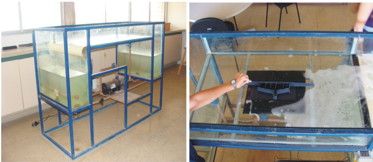
Figura 7 – Mesa d'água, equipamento utilizado para simulação de ventilação natural no modelo reproduzido da habitação em estudo.
