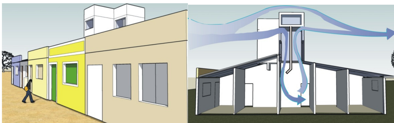
Figura 6 – Perspectiva e corte do modelo adaptado com defletor e com caixa d'água acima da torre.
