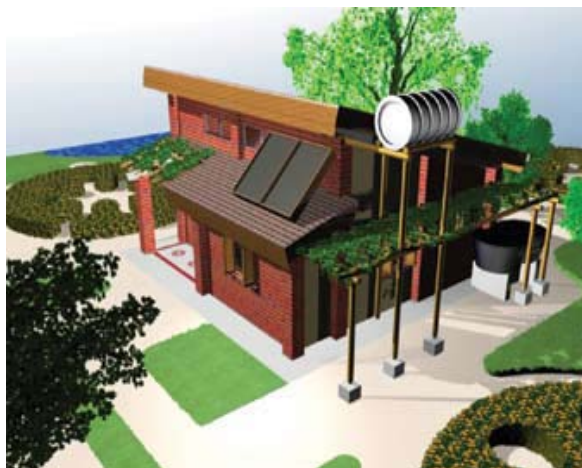
Figura 5- Perspectiva da edificação com os pergolados cobertos por vegetação durante o verão. Fonte: Sattler (2007)
