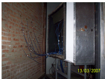
Figura 1a. Parede sendo ensaiada na caixa quente protegida.
