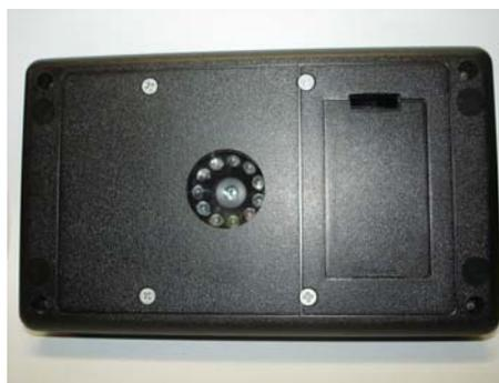
Figura 2 – Base do aparelho: conjunto de lâmpadas e sensor.
