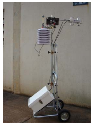
Figura 4 – Estação portátil para registros microclimáticos. Equipamentos numerados listados na Tabela 1. Sensores fixos na altura de 1.5m.
