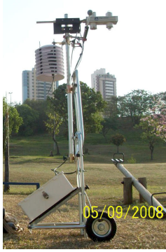
Figura 9 – Conjunto completo montado (case e sensores)
