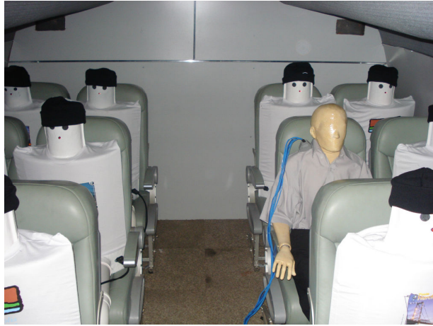
Figura 9 Posicionamento do manequim térmico e dos manequins aquecidos na cabine do mock-up
