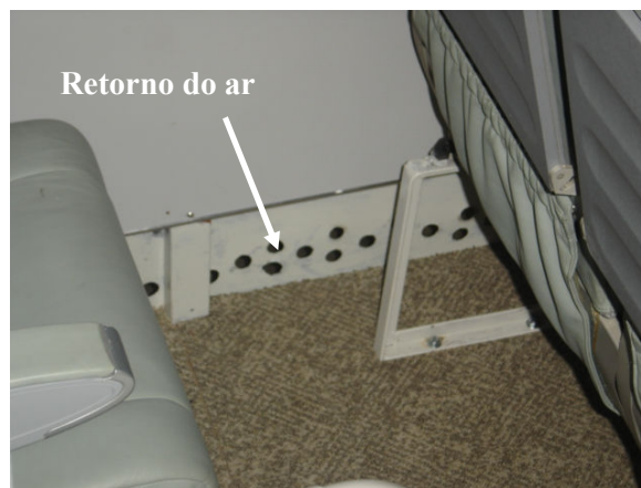
Figura 7 Detalhes do insuflamento e do retorno do ar no mock-up
