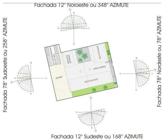
Figura 9 - Planta do lote do terreno da escola indicando orientação das fachadas de acordo com a carta solar de Salvador.
