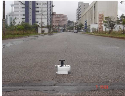
Figura 7 - Aparato para fotografia FVC locado no eixo da via Fonte: Arquivo das autoras
