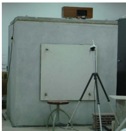
Figura 1 – Câmara acústica reverberante de dimensões reduzidas utilizada nos ensaios.
