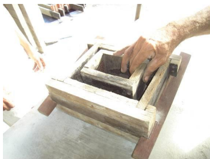
Figura 2. Foto da fôrma do elemento menor
