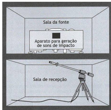
Figura 1 – Esquema de ensaio de isolamento de ruído de impacto. (Fonte: Brüel & Kjær, 1988)
