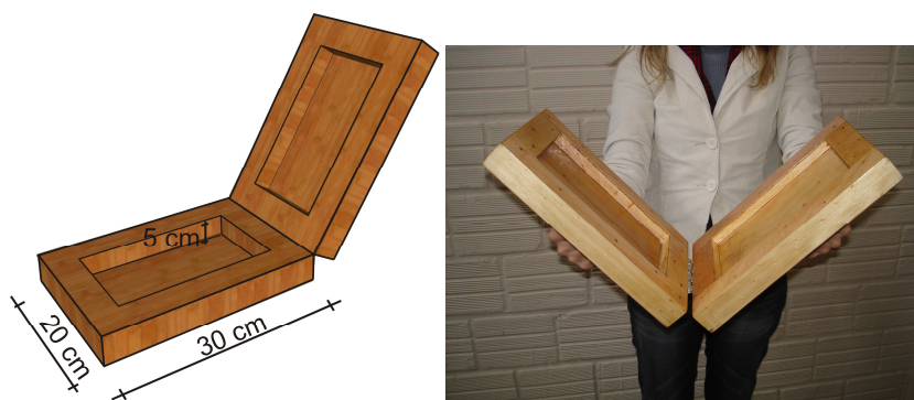
Figuras 1: Desenho esquemático e imagem da fonte impulsiva.
