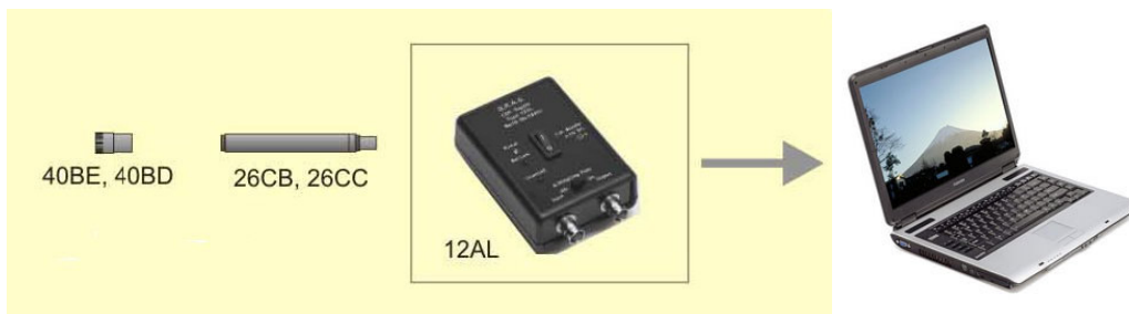
Figura 7 – Aparelhagem da cadeia de medição Fonte: http://www.gras.com .
