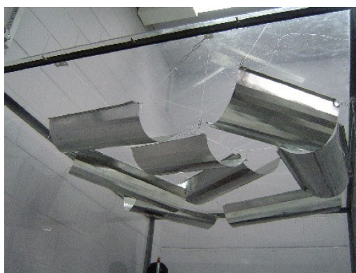
Figura 8 – Foto dos difusores metálicos dentro da câmara.
