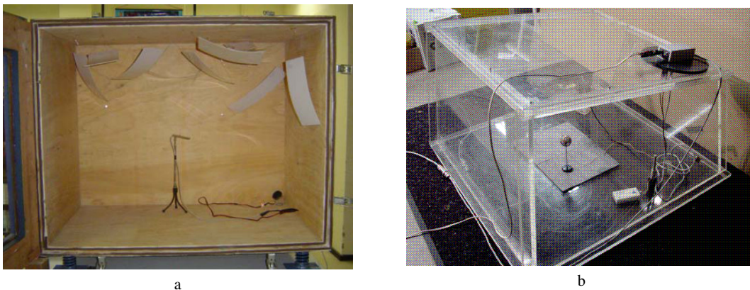
Figura 1 – (a) Modelo em escala de câmara reverberante para medições em escala 1:10. Fonte: Nascimento, Rany, L. X.; (2005). “Medição dos coeficientes de absorção sonora de materiais utilizados em modelos reduzidos”. Tese de Mestrado, COPPE/UFRJ, Rio de Janeiro, Brasil. (b) câmara reverberante em acrílico para medições em escala reduzida. Fonte: http://www.bksv.com/doc/bp1974.pdf
