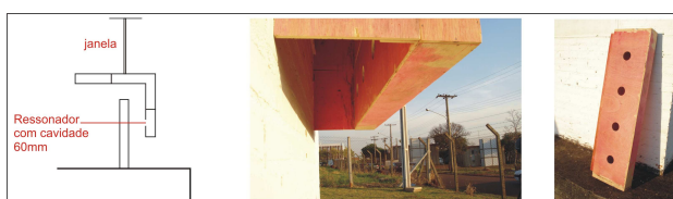
Figura 8 – Configuração 07: Janela com peitoril ventilado – Ressonadores na parte inferior da superfície interna do canal do peitoril ventilado.
