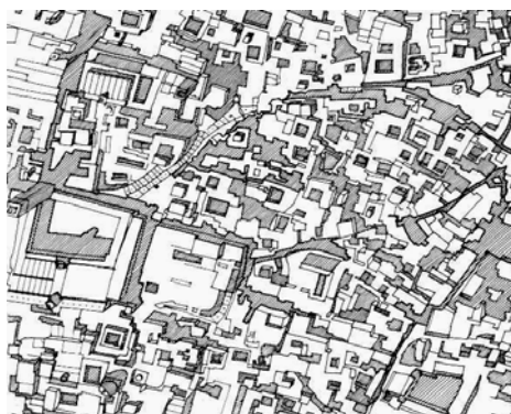
Figura 1 Representação gráfica, em vista aérea, de Tunis na Turquia e a sua disposição de edificações para melhor aproveitamento do sombreamento edilício. Fonte: Brown & Dekay (2004).
