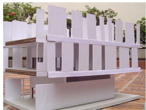
Figuras 3 y 4. Disponibilidad del recurso lumínico en la bóveda occidental calculado mediante registros de iluminancia obtenidos en el sitio. A la derecha modelo reducido con el que se midieron los factores de distribución lumínica ante diferentes condiciones de cielo.
