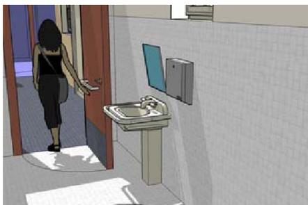
**Imagem 12 – Proposta de Adaptação de Sanitário na Procuradoria Geral do Estado, ampliação de passagem na abertura da porta, inclinação de espelho adequada.**
