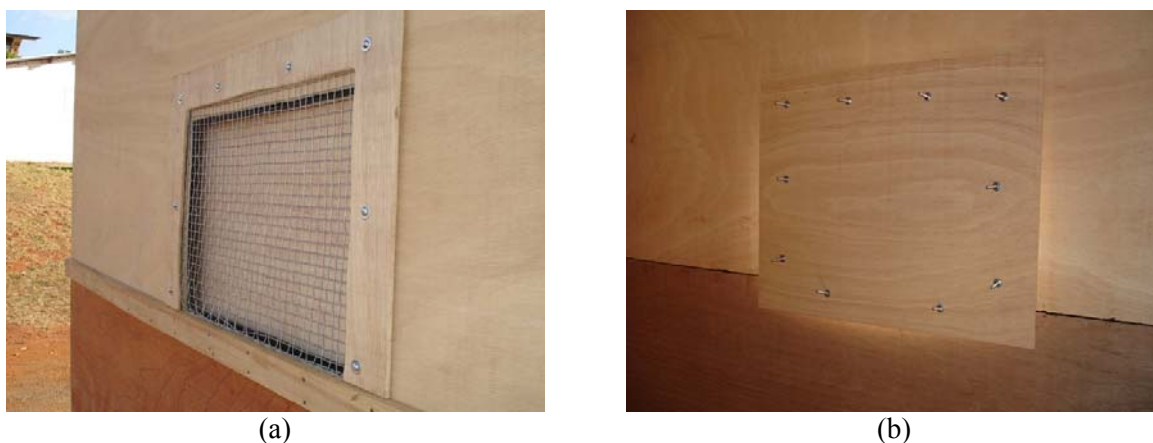
Figura 6 – (a) Vista externa do anteparo instalado na abertura da célula teste; (b) Vista interna do anteparo.
