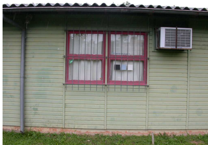
Figura 6 - Fachada utilizada para as medições com céu real: abertura com cortina branca e amostras com refletância conhecida
