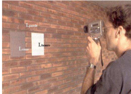
Figura 2 - Procedimento simplificado de medição da refletância (FONTOYNONT, 1999)
