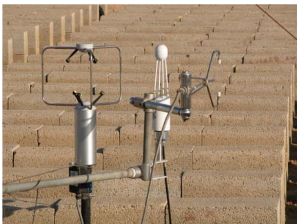
Figura 3: Anemômetro sônico tridimensional (à esquerda) e analisador de gás acoplado a um anemômetro sônico unidirecional
