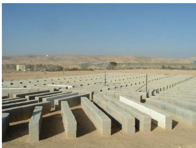
Figura 1: O modelo reduzido ( Open-Air Scaled Urban Surface - OASUS )
