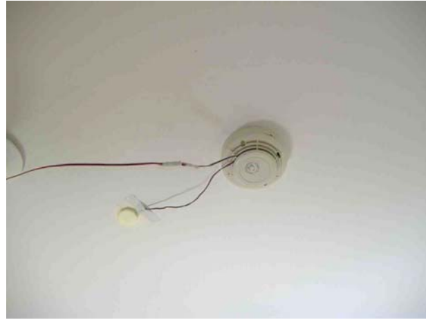
Figura 4_b: Sensor para medição da temperatura superficial
