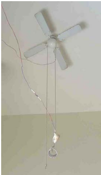
Figura 4_c: Sensores usados para medição do efeito de estratificação do ar
