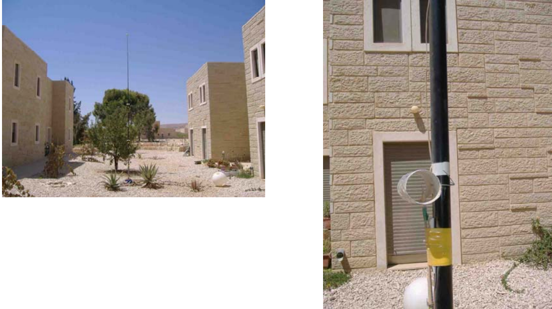
Figura 2: Mastro com termopares cobre-constantan ultrafinos, protegidos contra radiação solar direta, posicionado ao centro do cânion
