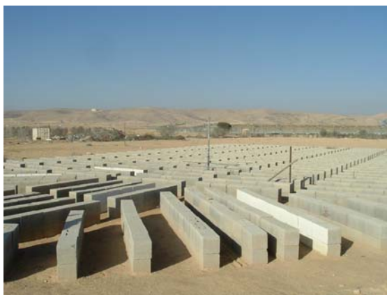
Figura 4: O modelo reduzido ( Open-Air Scaled Urban Surface - OASUS )
