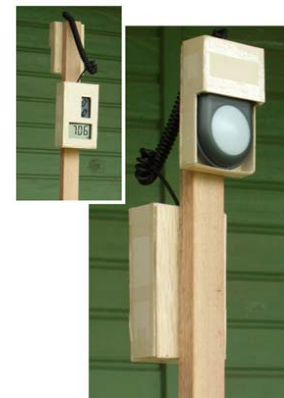
Figura 03. Suportes desenvolvidos para as medições de iluminância no plano da face do usuário.
