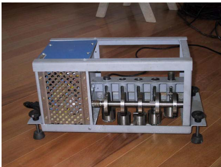
Figura 7 – Máquina geradora de ruído de impacto – Padrão ISO 140-6
