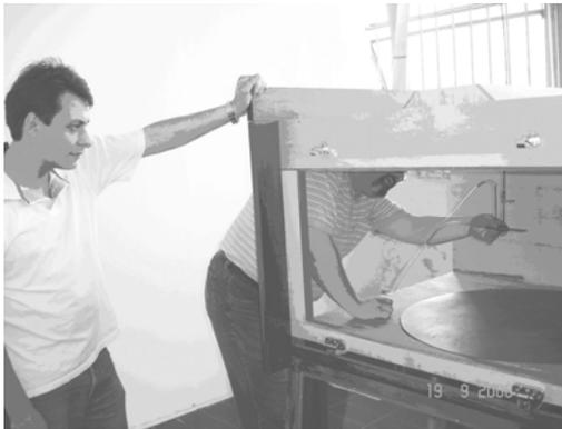
Figura 7 – Tubo de Pitot-Prandtl para medir os perfis de vento.
