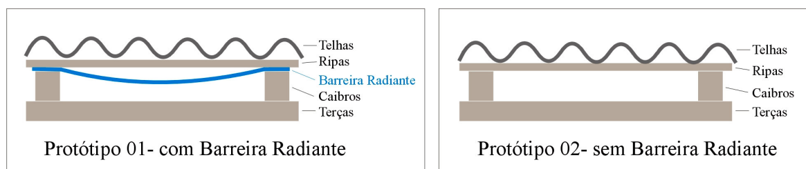
Figura 3 – Detalhes ilustrativos dos telhados
