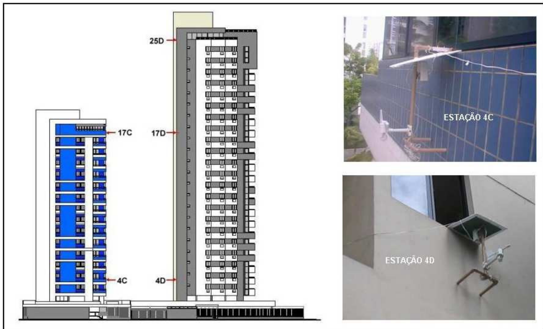
Figura 03: Posicionamento das mini-estações nas fachadas e sistema de fixação – maio 2005.
