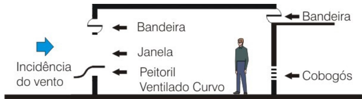
Figura 5 - Corte A-A' modelo com peitoril ventilado curvo
